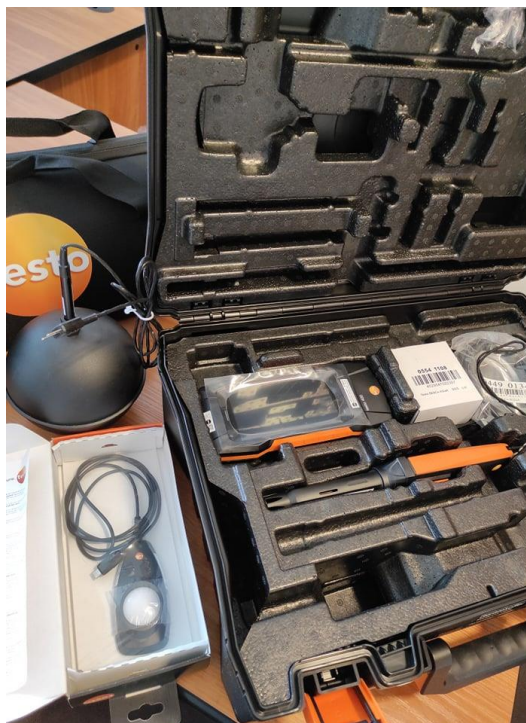
6. ábra Testo 400 IAQ és komfortérzet szett állvánnyal
