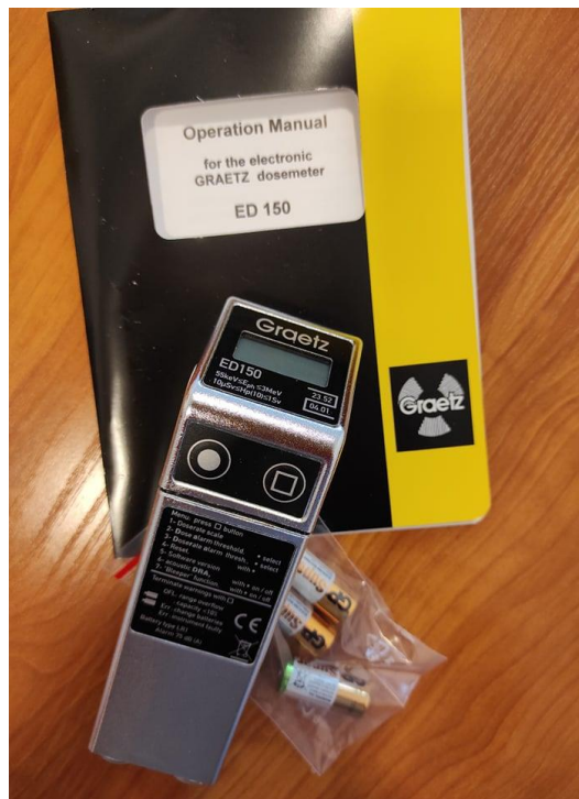
8. ábra Grimas - Graetz ED 150 dózismérő és dózisteljesítményjelző készülék
